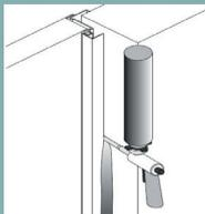
Füllen Sie den Zwischenraum vollständig mit Brandschutzschaum aus.
