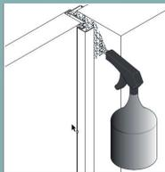
Sprühen Sie, nach dem Einsetzen der Eckzarge, den Raum zwischen Wand und Eckzarge mit Wasser ein.
