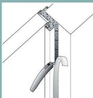
Entfernen Sie, nach dem Austrocknen, den überstehenden Brandschutzschaum mit einem Messer oder Cutter.
